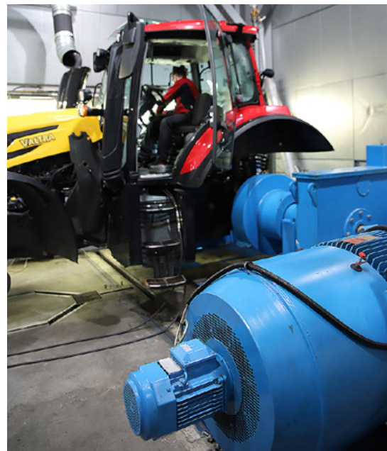
Jan-Erik Karjula kör traktorn i testbänken. Med hjälp av resultaten som fås från testbänken utvecklas förutom själva traktorn också simulatorm som gjorts på basen av den, så att den i framtiden motsvarar den riktiga traktorn ännu noggrannare.
