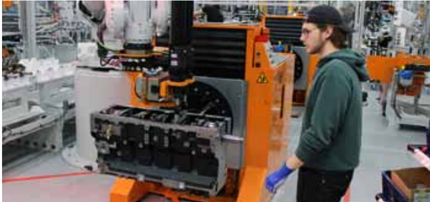
Montör Julius Salmela monterar en sexcylindrig motors vevaxel i samarbete med industriroboten.
