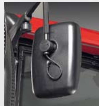
Sähköisesti ohjattavat ja lämmitettävät peilit parantavat näkyvyyttä ja turvallisuutta.
